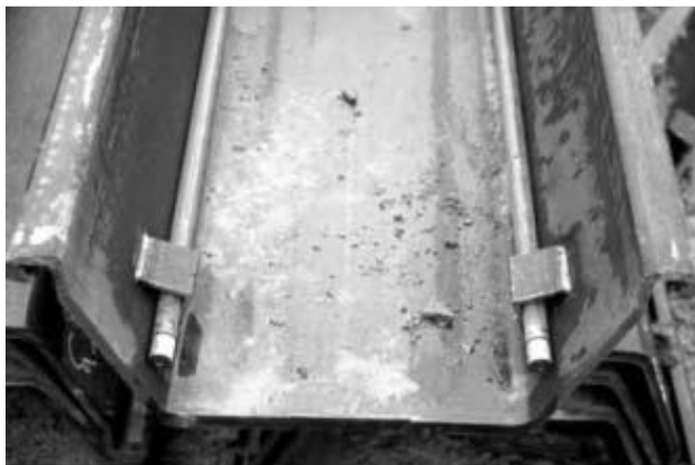
4 pav. Vamzdelių tvirtinimas prie įlaido
